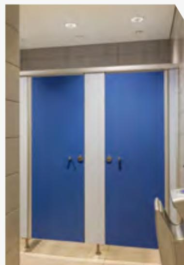
(1) Fermeture grâce à un bouton de porte en aluminium massif avec voyant libre/occupé intégré - à l'intérieur de la porte : verrou de fermeture en aluminium - à l'extérieur : bouton de porte en aluminium avec voyant libre/occupé intégré (rouge/blanc) Les cabines de déshabillage sont disponibles avec verrouillage central des deux portes et/ou un banc fixe ou rabattable.
