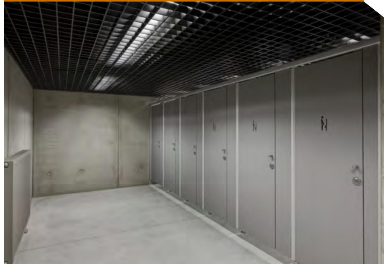
Dimensions : Les parois frontales des cabines ont une hauteur totale de 2000 mm ou de 2175 mm, pieds de 150 mm et raidisseur inclus. Autres hauteurs possibles sur demande. Largeur de la porte entre 550 et 900 mm, hauteur : 1775 ou 1955 mm. La largeur et la profondeur des cabines sont adaptées à la situation sur place.
