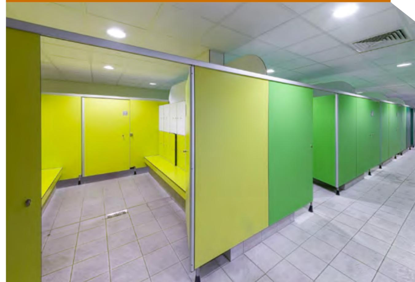
Le système ROGAPAL® FTS® + est utilisé pour la réalisation de cabines toilettes, douches et cabines de (change) déshabillage. Matériaux Les cabines sanitaires ROGAPAL® FTS® + sont fabriquées en stratifié massif HPL de 13 mm. Ce matériau est spécialement conçu pour les espaces humides. Il est très résistant à l'humidité et à la chaleur, hygiénique, résistant aux chocs, demande peu d'entretien et se prête parfaitement aux opérations de désinfection.
