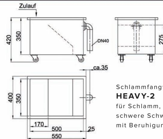
Schlammfangwagen **HEAVY-2** für Schlamm, Sand und schwere Schwebstoffe mit Beruhigungskammer
