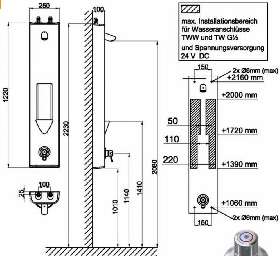
max. Installationsbereich für Wasseranschlüsse TWW und TW G½ und Spannungsversorgung 24 V DC
