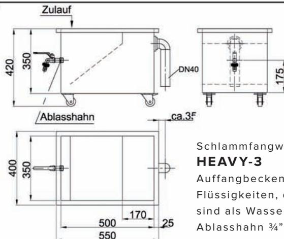
Schlammfangwagen **HEAVY-3** Auffangbecken für Flüssigkeiten, die leichter sind als Wasser mit Ablasshahn 3/4"
