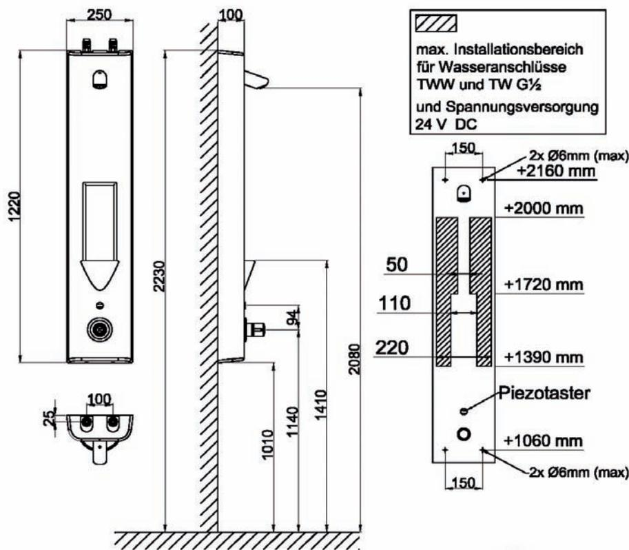
max. Installationsbereich für Wasseranschlüsse TWW und TW G½ und Spannungsversorgung 24 V DC
