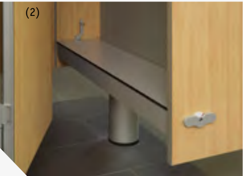
(3) Pied central sous la banquette de cabine. Cette solution permet de construire la cabine sans socles. Pour cela, une structure métallique est vissée sur le sous-plancher en béton avant même la pose de la chape, afin de garantir une très grande stabilité. La condamnation des deux portes de cabine est réalisée simultanément à l'aide de la planche inférieure de la banquette centrale. Le témoin « libre-occupé » de grande dimension, bien visible et comportant un dispositif d'ouverture de secours, en facilite l'usage.
